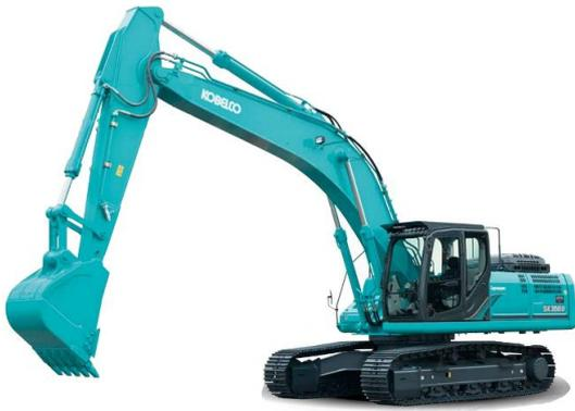
ハードな碎石作業に対応するため、高強度アタッチメントを標準装備した碎石専用機です。ブレーカ作業にも即座に対応できるようにN&B配管を標準装備し、本体側も各部を強化しました。過酷な碎石現場で性能を最大限に発揮できるマシンとなっています。碎石キャブやヘッドガード、消火器、回転灯、走行アラームなどの各種安全機能も標準装備し、碎石協会の適マークを取得した碎石現場の力強い味方です。
